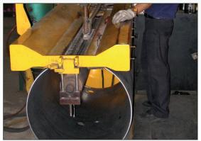
Longitudinal Joint Welding
